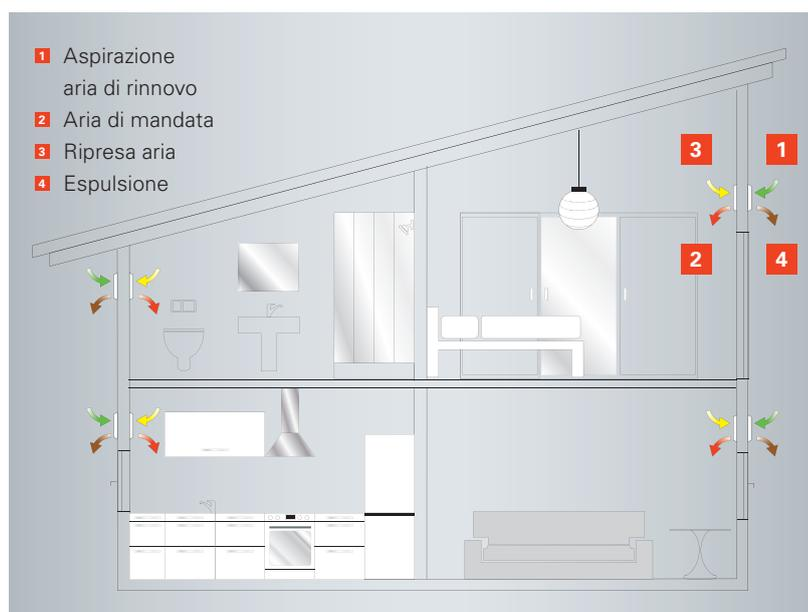
Possibilità d'installazione di Vitovent 200-D
